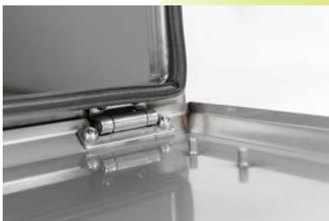
Volledig spatwaterdicht doordat de sponning met rubberen afdichting als rondlopende goot uitgevoerd wordt.
